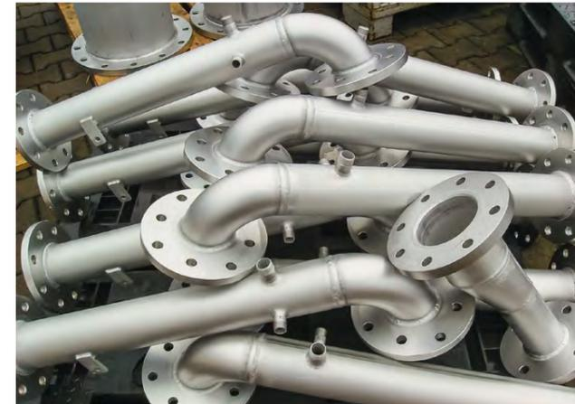
Formstückfertigung DN 100 bis DN 1000 Edelstahl
